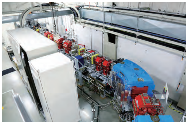
写真1 シンクロトロンの一部(青色部は粒子線を曲げるための電磁石)
